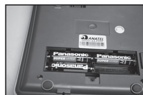
Disposição das pilhas dentro do compartimento do TI-200 (de acordo com a polaridade demonstrada na ilustração anterior)
